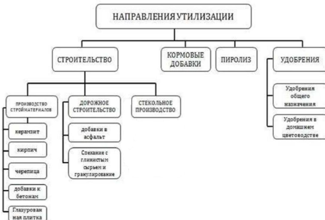
Рисунок 10 Направления утилизации осадков сточных вод
